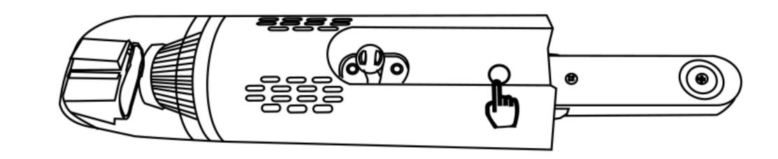
4. Pressione o botão liga/desliga para interromper o funcionamento e, em seguida, use os dois dedos para pressionar os dois lados da trava, enquanto empurra a alça de volta ao lugar original para
