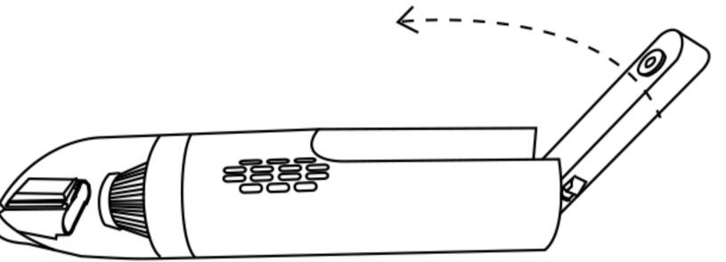
5. Gire para abrir o coletor de pó, retire o filtro e limpe o lixo, Se necessário, enxágue com água e seque naturalmente. Recoloque-o e rosqueie na direção oposta.
